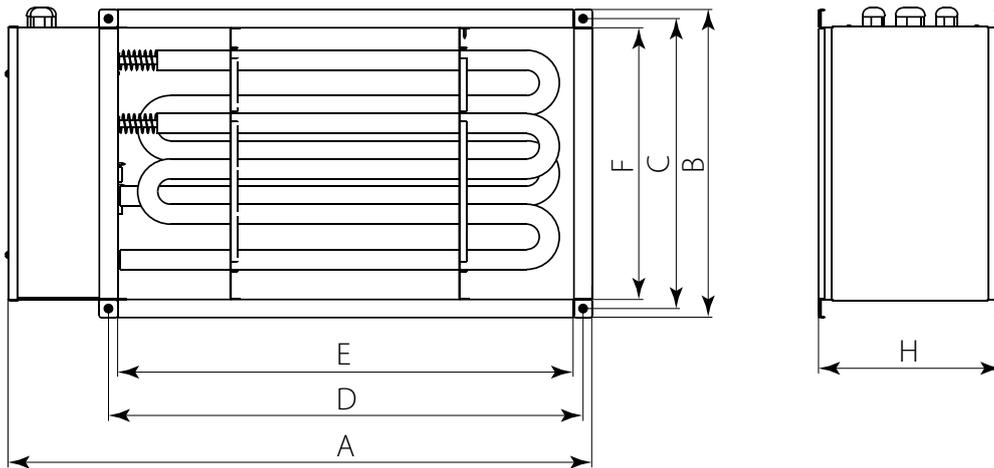
**AUßEN- UND ANSCHLUSSMASSEN DER HEIZREGISTER MIT RECHTECKIGEN LUFTKANÄLEN**
