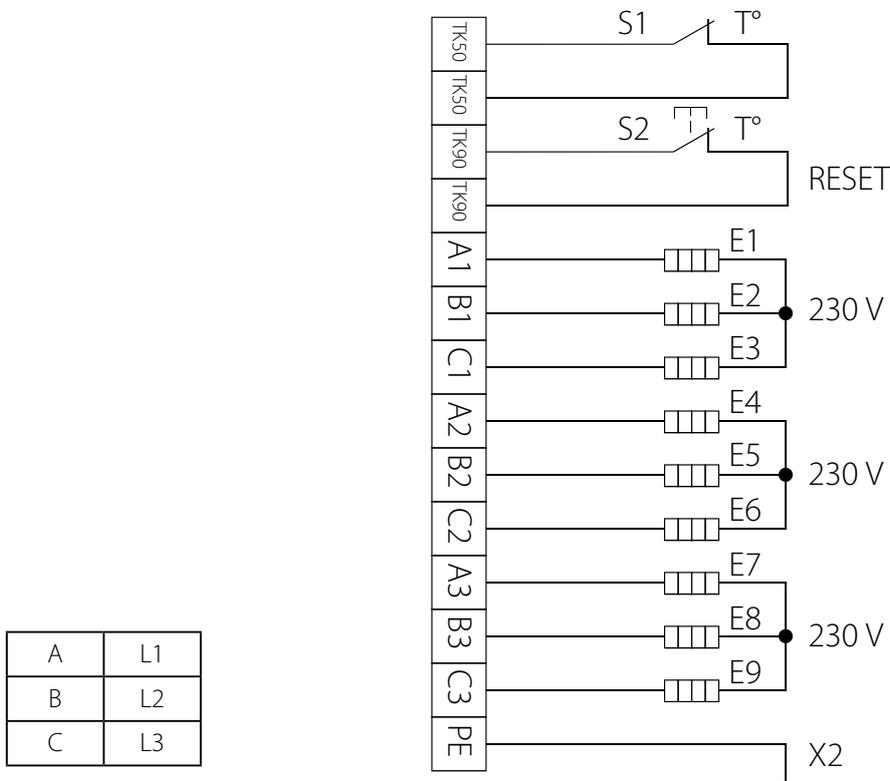
**SCHALTPLAN ZUM ANSCHLUS DES DREIPHASEN-HEIZREGISTERS MIT SECHS ROHRHEIZKÖRPERN,
