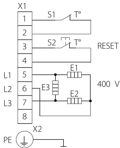
**ANSCHLUSSSCHEMA DES DREIPHASEN-HEIZREGISTERS MIT SECHS ROHRHEIZKÖRPERN,
