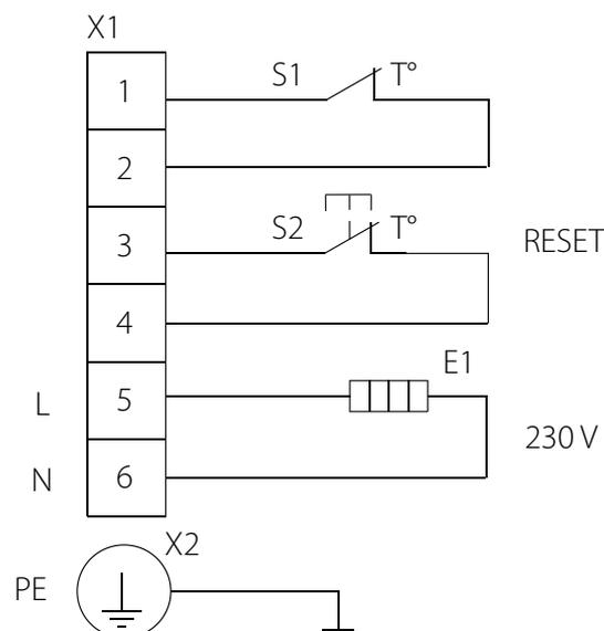
**ANSCHLUSSSCHEMA DES EINPHASEN-HEIZREGISTERS MIT ZWEI ROHRHEIZKÖRPERN**
