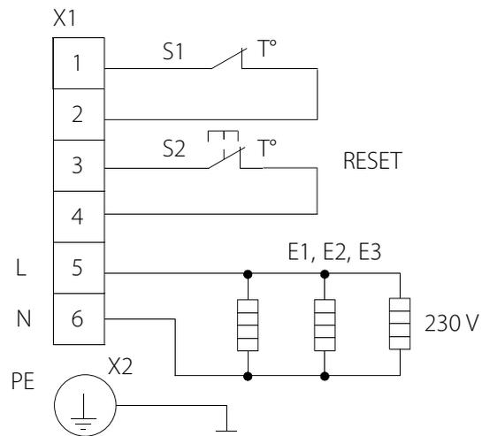
**ANSCHLUSSSCHEMA DES DREIPHASEN-HEIZREGISTERS MIT DREI ROHRHEIZKÖRPERN**
