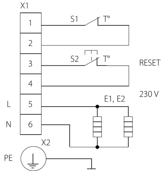
**ANSCHLUSSSCHEMA DES EINPHASEN-HEIZREGISTERS MIT DREI ROHRHEIZKÖRPERN**
