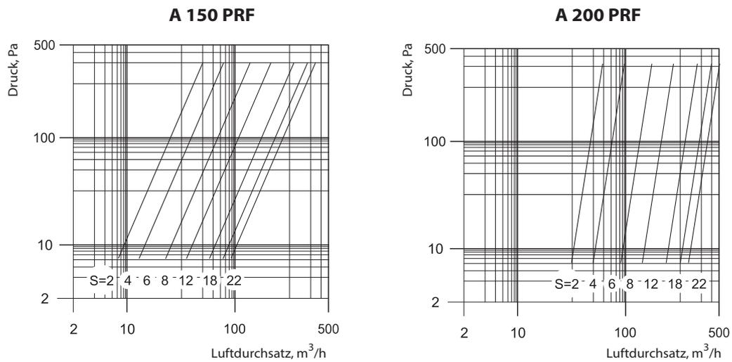
Der Innenteil des Ventils wird so verdreht, dass der Spalt S (mm) gesichert wird, um einen erforderlichen Luftdurchsatz gemäß dem Diagramm zu erzeugen.
