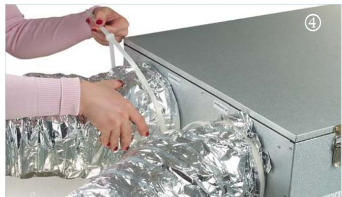
Bedecken Sie die Flansche des Montagesatzes NM Isovent mit der Außenschicht der wärmeisolierten Lüftungsrohre durch das Drücken gegen das Gehäuse der Lüftungsanlage. Danach fixieren Sie die Außenisolationsschicht mit den Montage-Schlauchschellen aus dem Lieferumfang.
