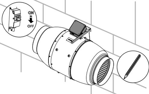
Führen Sie das Stromkabel zur Lüftungsöffnung, bohren Sie die Befestigungslöcher und setzen Sie die Dübel ein.
