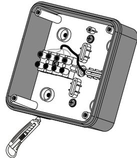
Schließen Sie die Stromkabel an die Klemmleiste an. Setzen Sie den Ventilator in umgekehrter Reihenfolge wieder zusammen.
