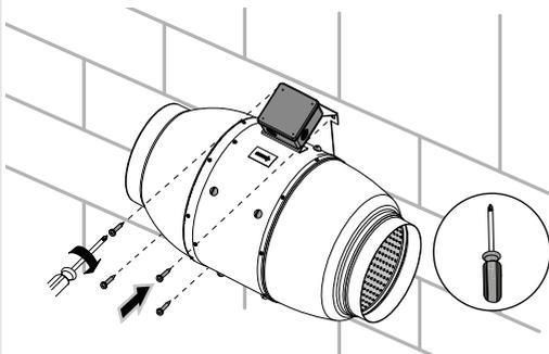
Bei beliebiger Einbaulage: schließen Sie ein Lüftungsrohr auf beiden Seiten des Ventilators an.
