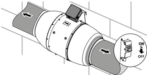
Reinigen Sie den Ventilator mit einem weichen Tuch oder Pinsel.
