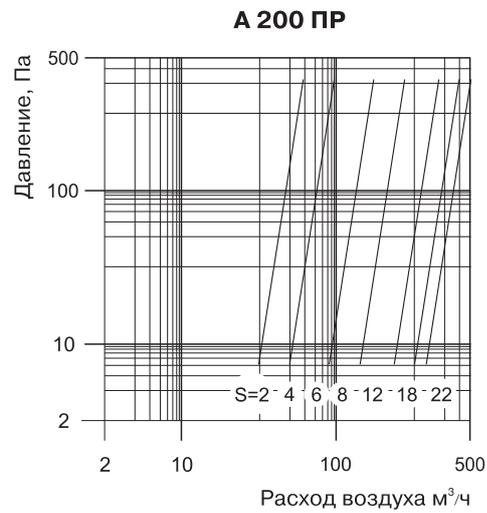
Внутренняя часть клапана выкручивается на определенное количество оборотов таким образом, чтобы обеспечить зазор S (мм), соответствующий требуемому расходу воздуха, определяемому по графику.
