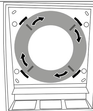
5. Зафиксируйте тыльную часть и ливнесток вентиляционного колпака на стене шурупами 4x40 из комплекта поставки.
