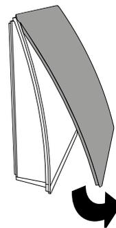
4. Для монтажа воздуховода диаметром 160 мм снимите переходник на тыльной части. Для этого поверните его по часовой стрелке.
