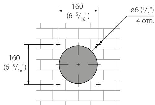
3. Установите дюбели 6x40 из комплекта поставки в отверстия. Снимите наружный вентиляционный колпак для обеспечения доступа к крепежным отверстиям. Для этого потяните фронтальную часть снизу на себя.
