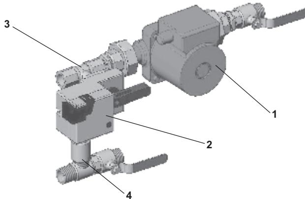
Циркуляционный насос 1 обеспечивает непрерывный водяной поток требуемого давления, при этом температура воды, поступающей в теплообменник, регулируется смешением в циркуляционном кольце воды, поступающей из сети, с отработанной водой, поступающей из теплообменника. Количество отработанной воды, направляемой по перемычке 4, регулируется трехходовым клапаном 3 и электроприводом 2, управляющее напряжение которого определяется заданной температурой приточного воздуха, выходящего из теплообменника.
