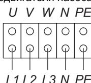
Схема подключения электродвигателя насоса трехфазного 3x400В
