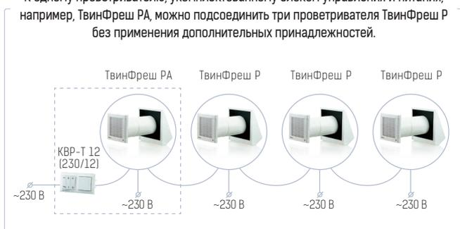
При необходимости объединить в сеть большое количество проветривателей можно применить одну панель управления КВР и несколько трансформаторов.
