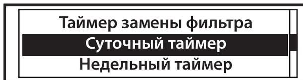
Позволяет пользователю установить время включения и время выключения **установки «ВПА»**. При активизации данного режима **установка «ВПА»** будет автоматически включаться и выключаться в установленное время каждые сутки и так до отключения данного режима. При этом в позиции **«текущий режим работы»** главного рабочего окна будет индицироваться «С», что говорит пользователю о включенном суточном таймере.
