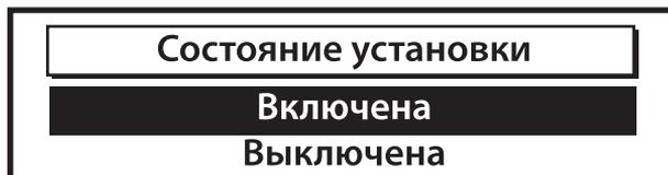
Кнопками **Up/Down** или кнопкой **Power** выбираем желаемую позицию, кнопкой **Enter** переводим **установку «ВПА»** в соответствующее состояние (включена/выключена). При выключении **установки «ВПА»** задействуется следующий алгоритм:
