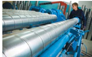
Werkstatt für Wickelfalzrohre
