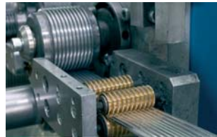
Werkstatt für flexible Lüftungsrohre
