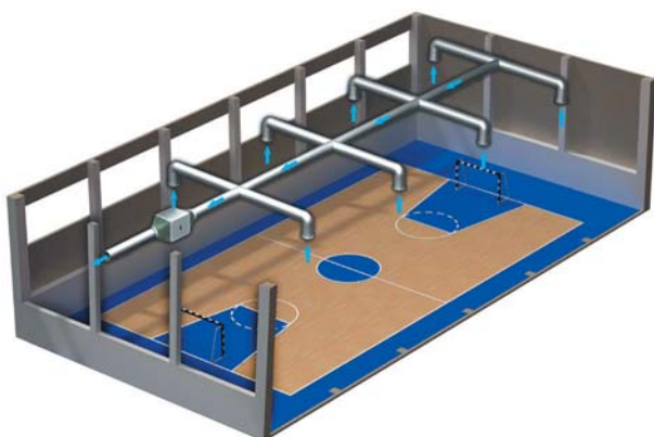
Einsatzbeispiel von Ventilator VS im Fitnessraum
