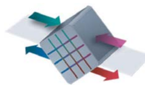
Wirkungsweise des Kreuzstrom-Plattenwärmetauschers
