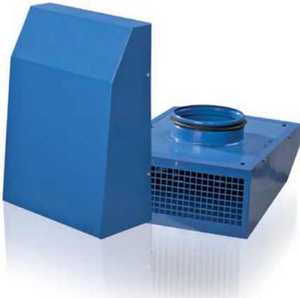
Abluft-Radialventilator im Stahlgehäuse für Außenwandmontage mit einer Luftförderleistung von bis zu 710 m 3 /h
