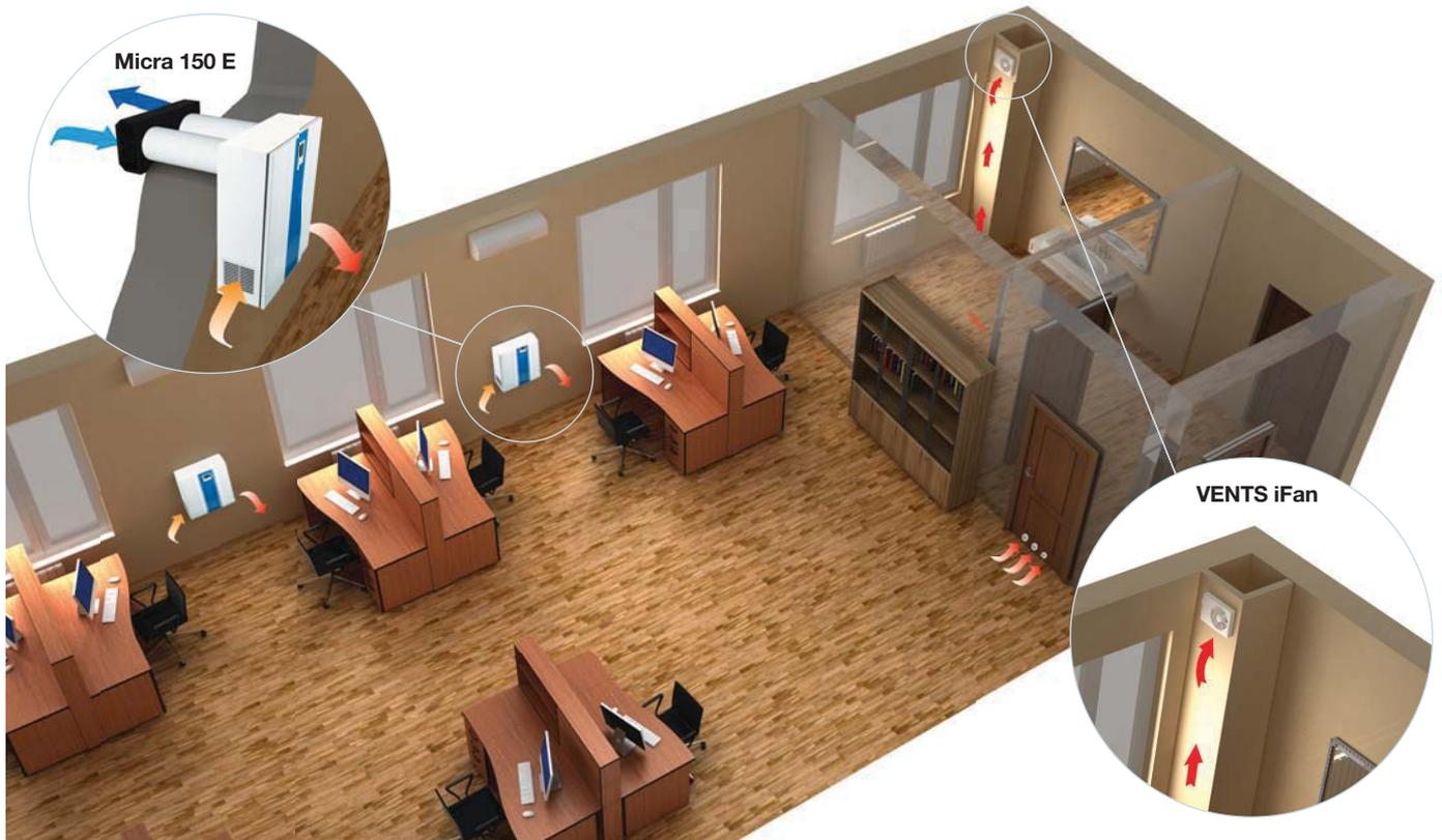
Die Lüftungsanlage MICRA 150 E ist für die Montage durch Außenwand im Innenraum konstruiert. Die Mindestwandstärke ist 100 mm.
