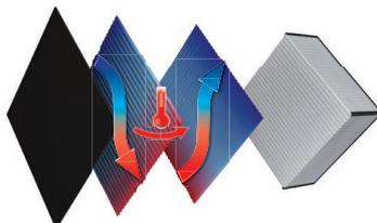
Die Lüftungsanlagen **VUE H2/V2 mini EC** sind mit einem Gegenstrom-Wärmetauscher aus polymerisiertem Zellstoff ausgestattet. In der kalten Jahreszeit werden die Wärme und Feuchte der Abluft über die Enthalpiemembran auf die Zuluft übertragen, was den Wärmeverlust durch die Lüftung reduziert. In der warmen Jahreszeit werden die Wärme und Feuchte der Außenluft über die Enthalpiemembran
