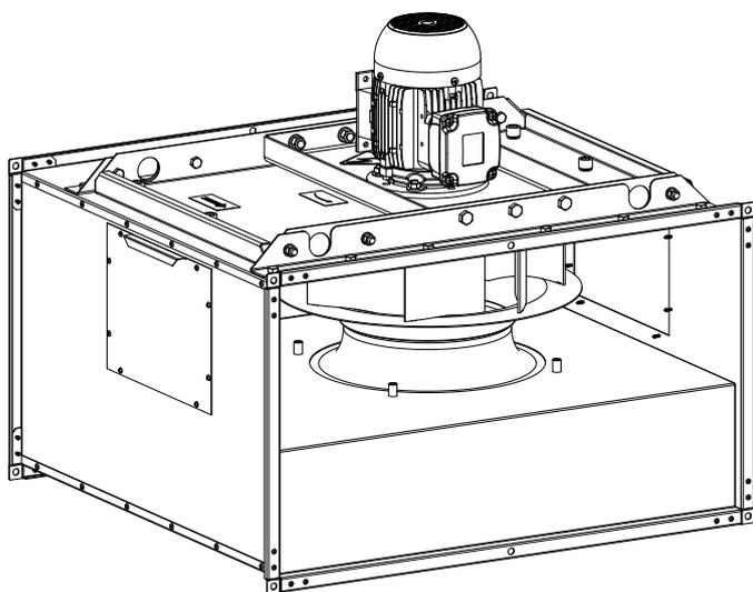
Das Ventilatorgehäuse besteht aus verzinktem Stahl. Für regelmäßige Überprüfungen sind am Ventilatorgehäuse Revisionsklappen vorgesehen. Der Elektromotor ist außerhalb des Luftstroms montiert. Das Laufrad mit rückwärts gekrümmten Schaufeln besteht aus hitzebeständigem Stahl. Zur Drehzahlsteuerung kann der Ventilator mit einem Frequenzumrichter ausgestattet werden (nicht im Lieferumfang enthalten, separat erhältlich).
