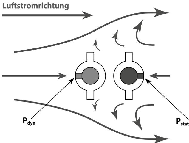
ZVP-Sonden laufen nach dem Pitotrohr-Prinzip. Der Gesamtdruck  $P_{total}$  wird an einer der Oberflächen der Sonde gemessen. Der statische Druck  $P_{stat}$  wird auf der gegenüberliegenden Seite gemessen. Die Differenz zwischen diesen Drücken ist der dynamische Druck  $P_{dyn}$ , der durch die folgende Formel ausgedrückt wird:
