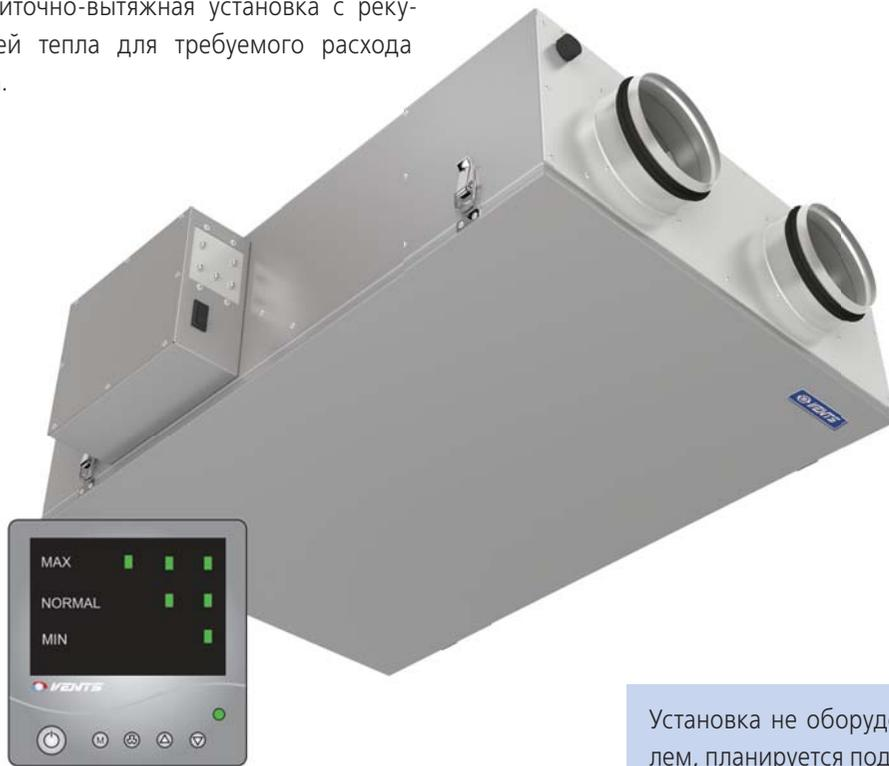
Установка не оборудована дополнительным нагревателем, планируется подавать свежий воздух в помещение зимой слегка охлажденным. В пиковые нагрузки, при критичных наружных температурах, снижать производительность установки до 1-й скорости для увеличения КПД рекуперации и во избежание дополнительных теплотерь.
