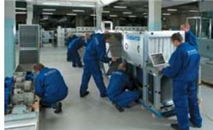
Цех изготовления приточно-вытяжных агрегатов AirVents
