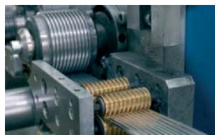
Цех изготовления гибких воздуховодов
