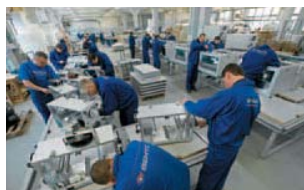
Цех изготовления приточно-вытяжных установок
