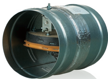
Нормально открытый огнезадерживающий каналный клапан с плавкой вставкой и обратной пружиной
