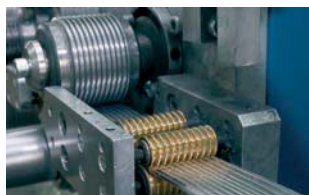
Цех изготовления гибких воздуховодов
