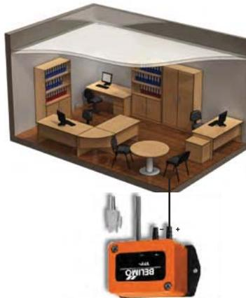
При необходимости поддержания пониженного давления в помещении трубку "-" следует провести от датчика в помещении, а трубку "+" провести в помещении с эталонными условиями (коридор, потолочное пространство и т.д.).
