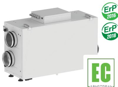
тепло и влага вытяжного воздуха передаются приточному сквозь энтальпийную мембрану, что снижает потери тепла за счет вентиляции. В теплый период года тепло и влага уличного воздуха передается сквозь энтальпийную мембрану вытяжному воздуху. Таким образом приточный воздух попадает в помещение более прохладным и сухим, что существенно снижает нагрузку на кондиционер.
