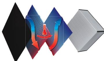
Установки ВУЭ Г2/В2 мини ЕС оборудованы рекуператором перекрестного тока, выполненным из полимеризованной целлюлозы. В холодный период года
