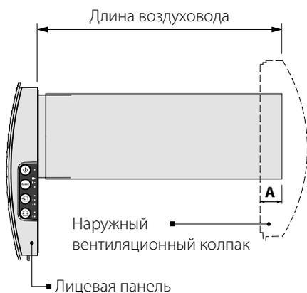
Длина воздуховода зависит от модели проветривателя (см. «Структура условного обозначения»).
