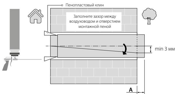
При монтаже воздушного канала обеспечьте уклон со стороны улицы минимум на 3 мм вниз.
