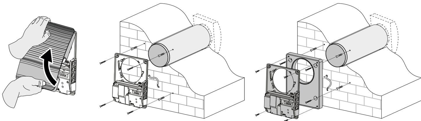
5. Открутите два самореза, удерживающих клеммную крышку, для доступа к клеммам подключения.
