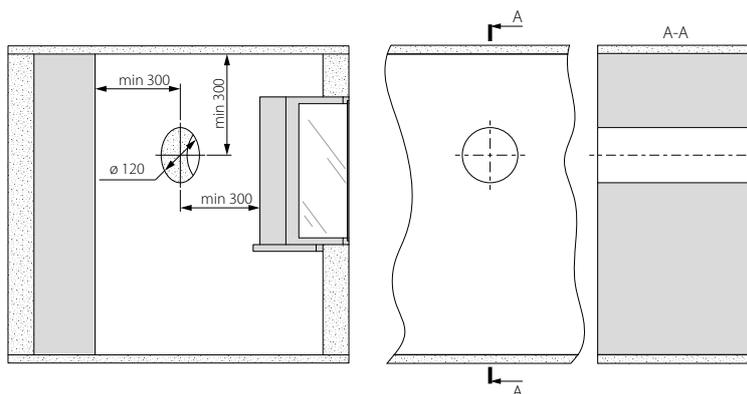
2. Установите воздуховод в стене. Для удобства монтажа используйте пенопластовые клинья, входящие в комплект поставки. С наружной стороны стены воздуховод должен выступать на расстояние, необходимое для установки наружного вентиляционного колпака. Расстояние А указано в руководстве к внешнему вентиляционному колпаку.
