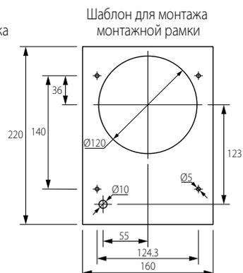
4. Отделите лицевую панель комнатного блока от тыльной части, потянув за язычок снизу. При использовании монтажной рамки закрепите её на стене.
