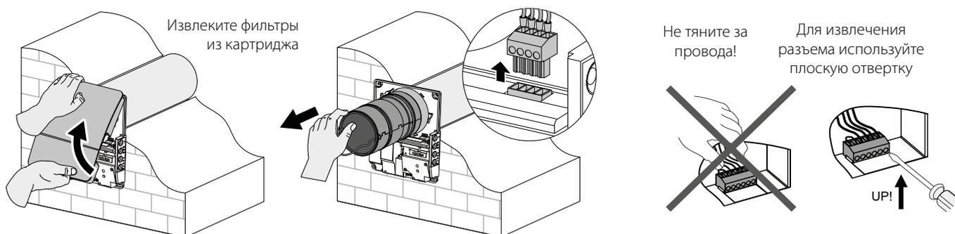
Обнулите отсчет таймера фильтра в приложении Vents Home на мобильном устройстве или удерживая кнопку
