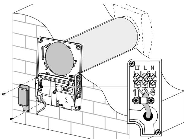
6. Вставьте картридж в канал, подключите разъем картриджа к контроллеру. Установите фронтальную часть комнатного блока на предыдущее место.
