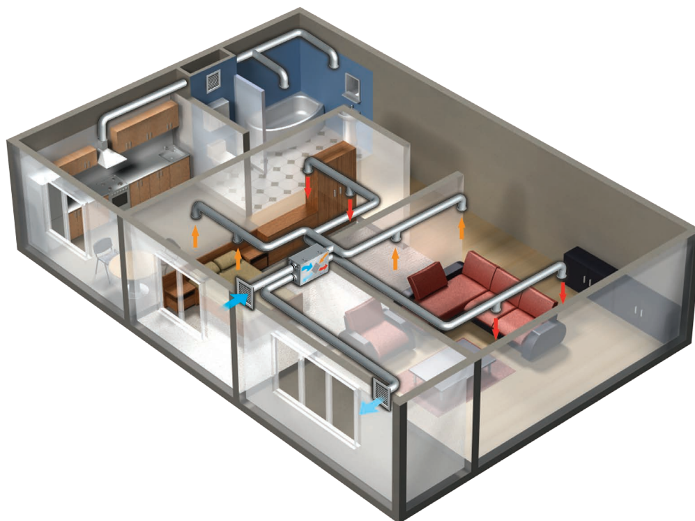
Вариант применения ВУТ Г для организации воздухообмена в квартире
