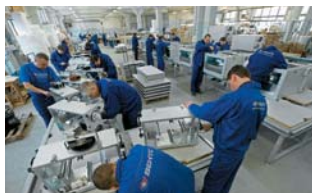
Цех изготовления приточно-вытяжных установок
