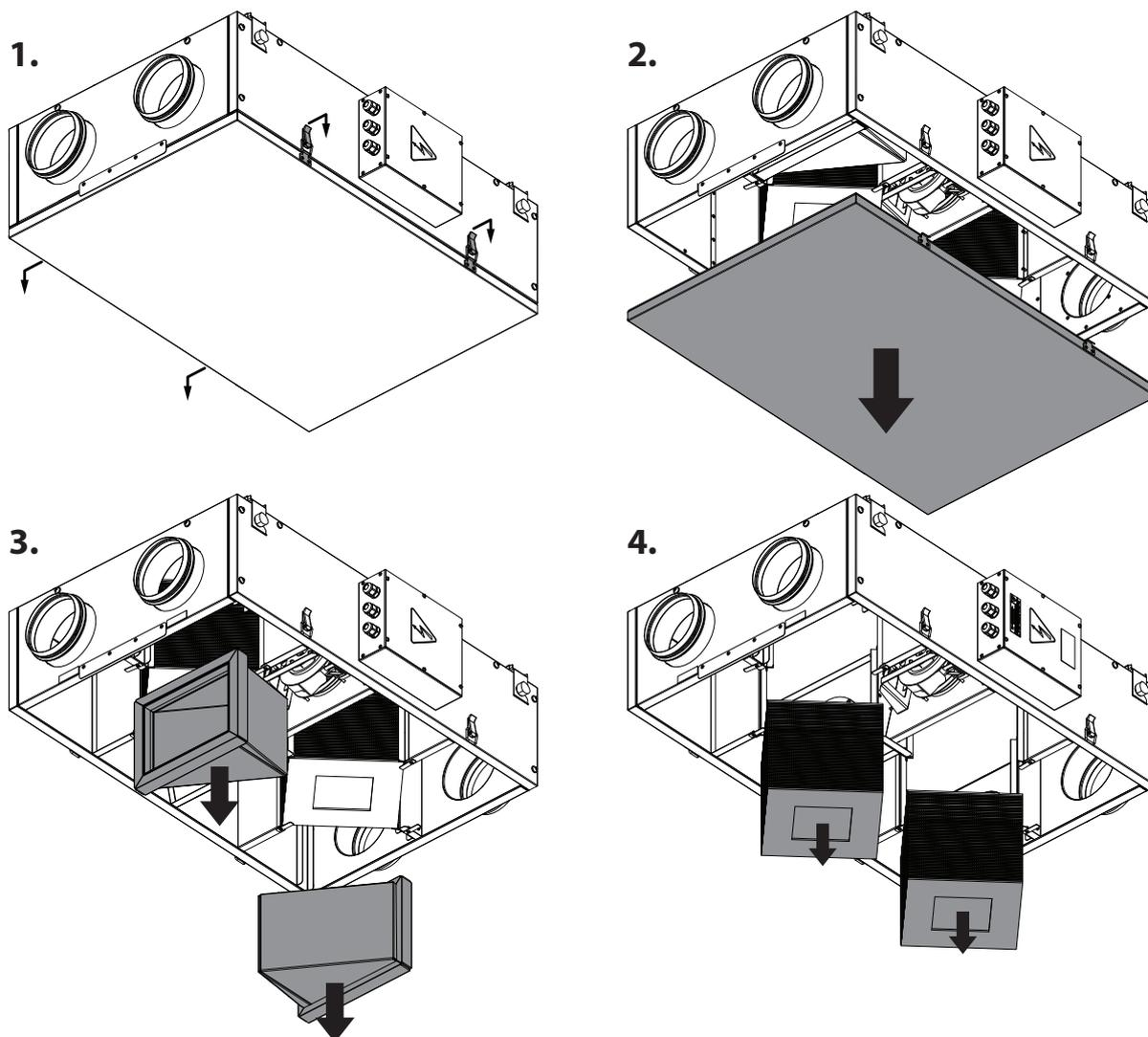
Рис. 14. Извлечение фильтров и рекуператора
