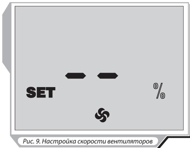
Рис. 9. Настройка скорости вентиляторов
