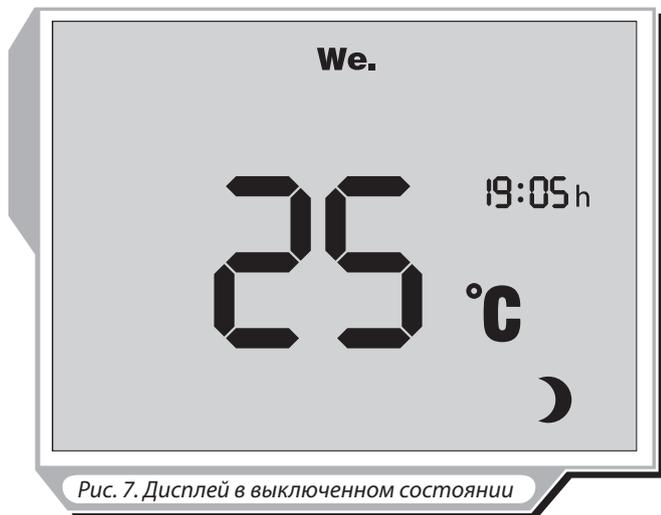
Рис. 7. Дисплей в выключенном состоянии
