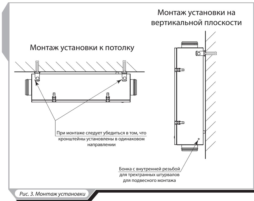
В установке отсутствует дренажный поддон, что делает возможным монтаж установки в любом положении, обеспечивающем свободный доступ для обслуживания.
