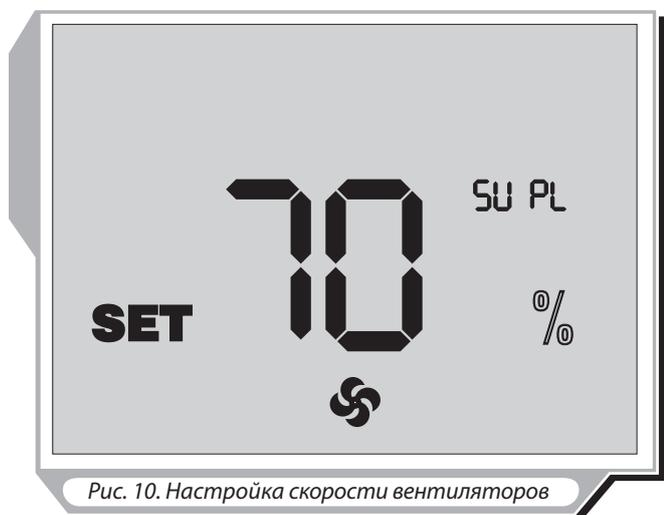
Рис. 10. Настройка скорости вентиляторов
