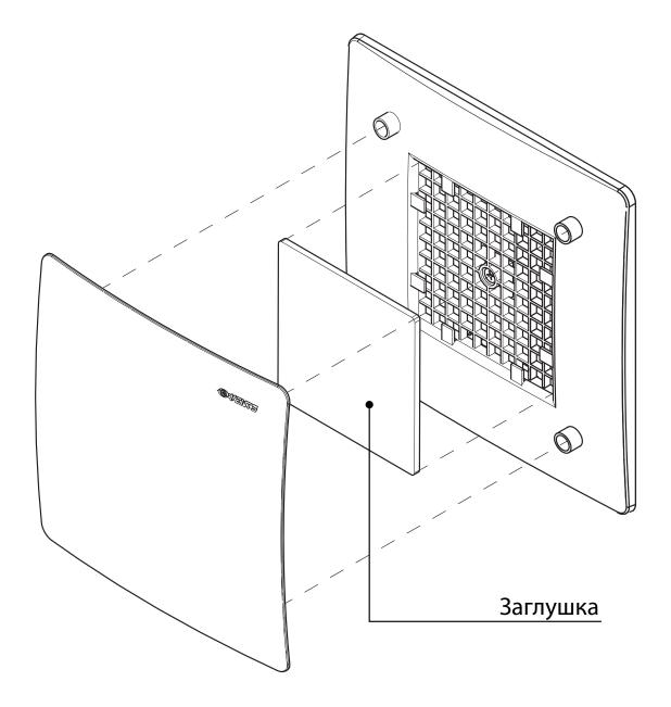
В комплекте с агрегатом поставляется специальная заглушка в виде силиконовой пластины, служащая для герметизации вентиляционного канала во время длительного перерыва в работе устройства. Заглушка предотвращает обратный поток воздуха и минимизирует теплопотери.
