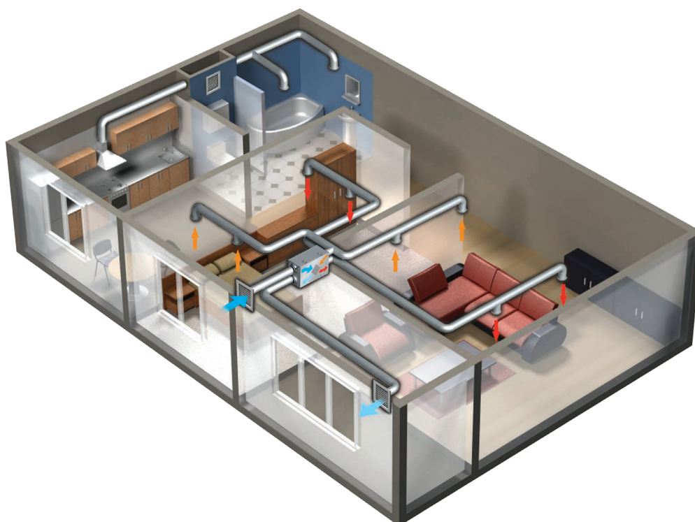
Варіант застосування ВУТ Г для організації повітрообміну в квартирі
