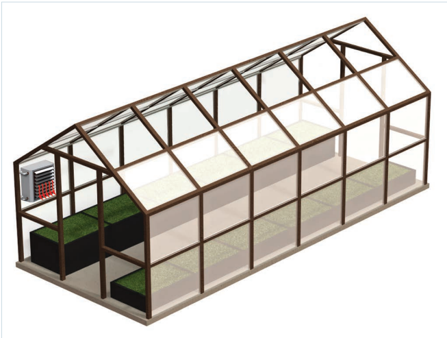
Варіант застосування охолоджувального агрегата АОВ в теплиці
