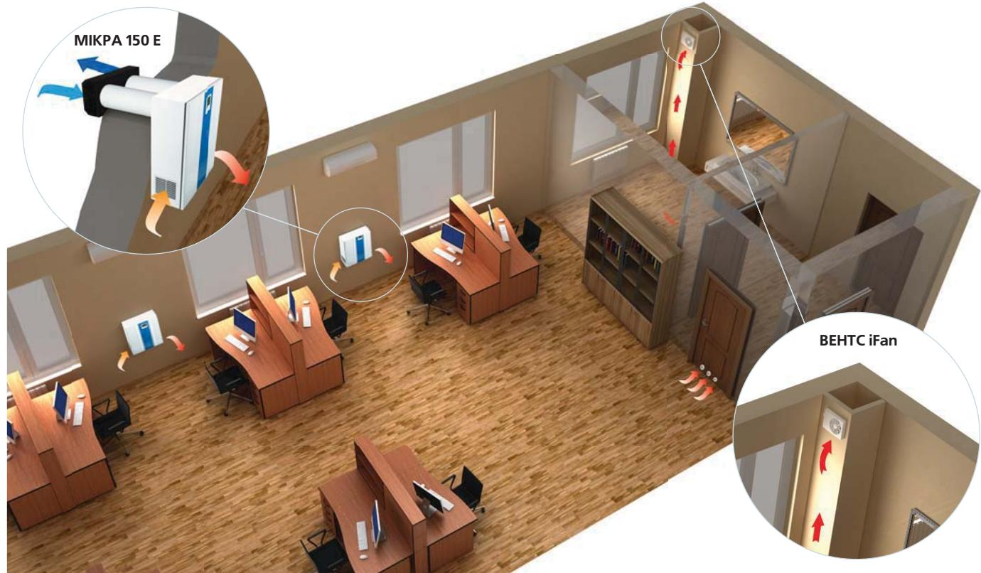
Припливно-витяжна установка **МІКРА 150 Е** монтується на фасадну стіну приміщення товщиною не менше 100 мм. На початку монтажу за допомогою картонного шаблону, який входить до комплекту поставки, на стіні розмічаються отвори для повітропроводів. Після висвердлювання отворів картонний шаблон кріпиться до стіни за допомогою дюбелів та шурупів.
