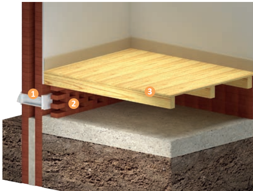
Рис. 33. Конструкція простору під підвісною дерев'яною підлогою
