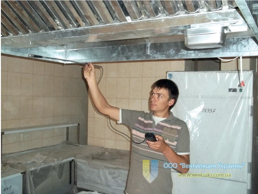
Рис. 64. Вимірювання швидкості повітря анемометром
