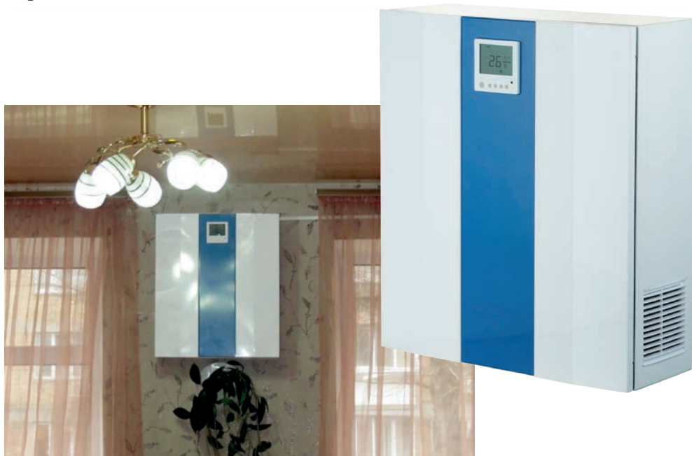
Рис. 16. Установка серії Мікра 150 (настінний варіант монтажу) продуктивністю 20–150 м 3 /год з пластинчастим рекуператором (ефективність до 75 %) та позисторним нагрівачем 350 Вт.
