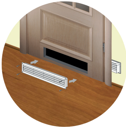
Рис. 52. Встановлення припливно-витяжної решітки MB 450
