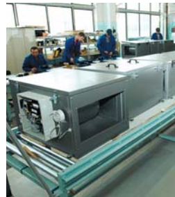
Цех изготовления приточно-вытяжных установок
