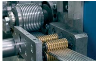
Цех изготовления гибких воздуховодов
