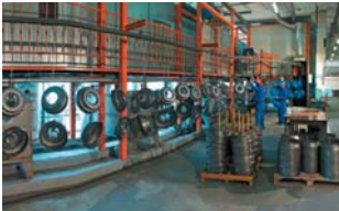
Цех порошковой покраски
