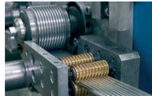
Цех изготовления гибких воздуховодов
