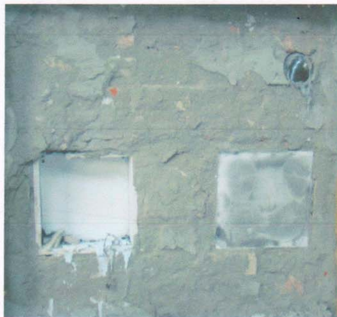
Вигляд зразків зі сторони вогневого впливу після випробування
