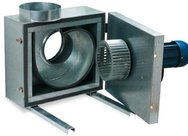
Die Stutzen sind gummigedichtet zum dichten Anschluss an die Lüftungsrohre. Der Ventilator wird auf die Tragrahne mit eingebauten Schwingungsisolatoren montiert.
