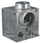
Wenn die Lufttemperatur im kaminnahen Bereich den Sollwert erreicht, schaltet der Ventilator automatisch ein, Abb. 1b, und verteilt die durch den Kamin erhitzte Luft in die Nebenräumen. Nach der Temperaturabsenkung unter den Sollwert schaltet der Ventilator aus, Abb. 1a.
