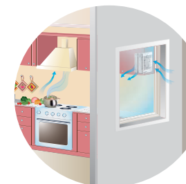
Вентилятор работает в реверсивном режиме ПРИТОК - ВЫТЯЖКА
