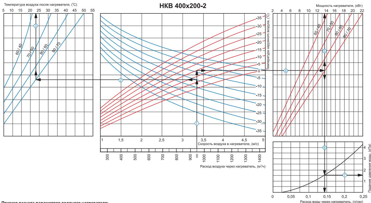
**Пример расчета параметров водяного нагревателя:**
