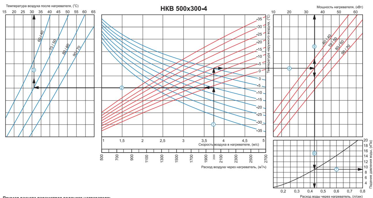
**Пример расчета параметров водяного нагревателя:**
