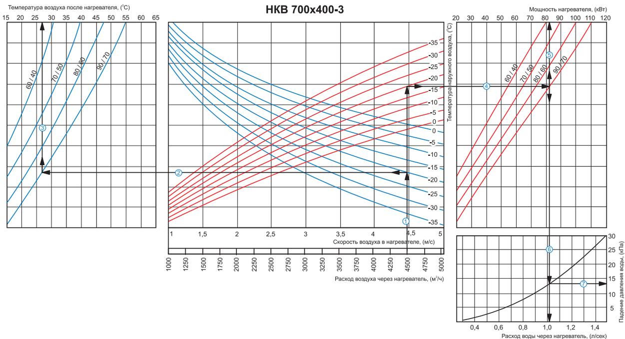
**Пример расчета параметров водяного нагревателя:**
