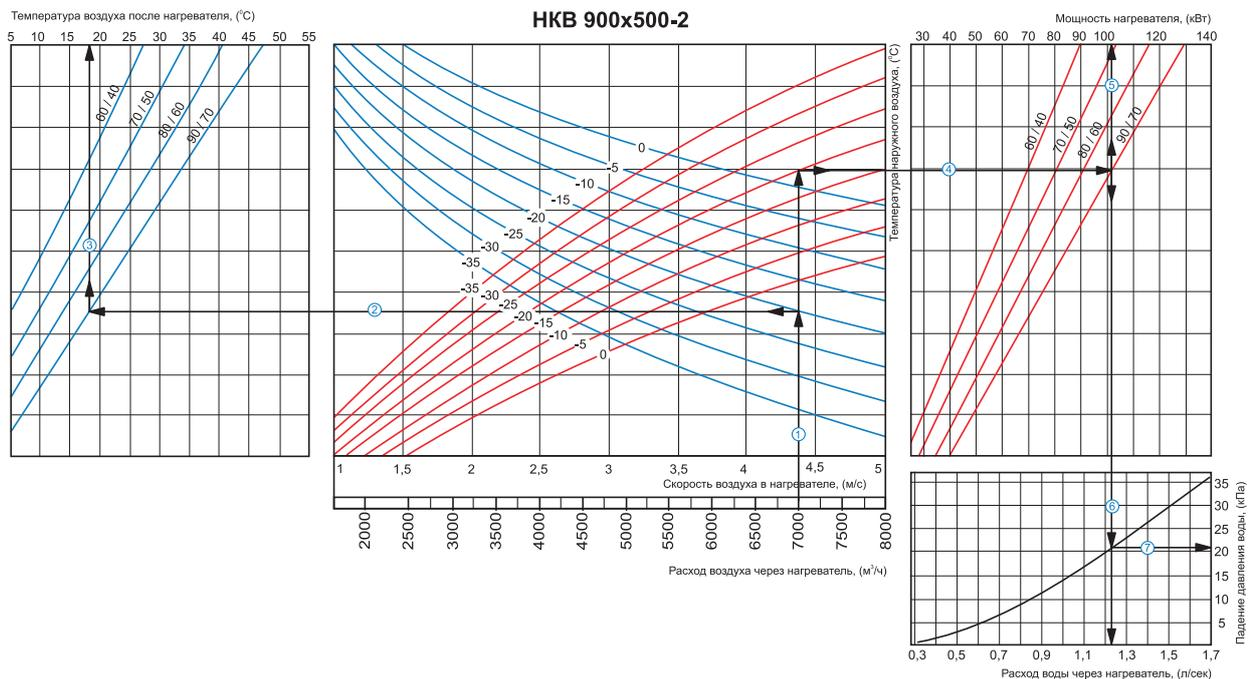
**Пример расчета параметров водяного нагревателя:**
