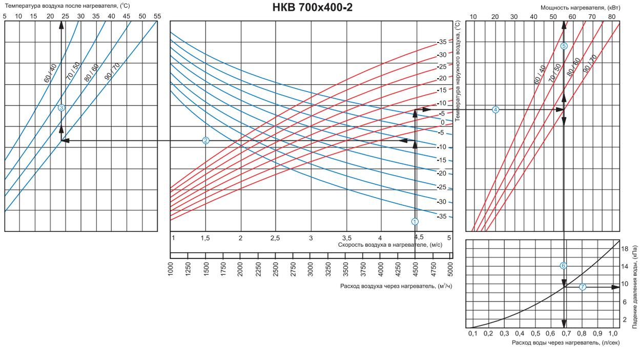
**Пример расчета параметров водяного нагревателя:**
