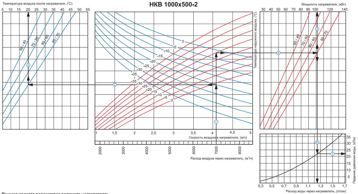
**Пример расчета параметров водяного нагревателя:**
