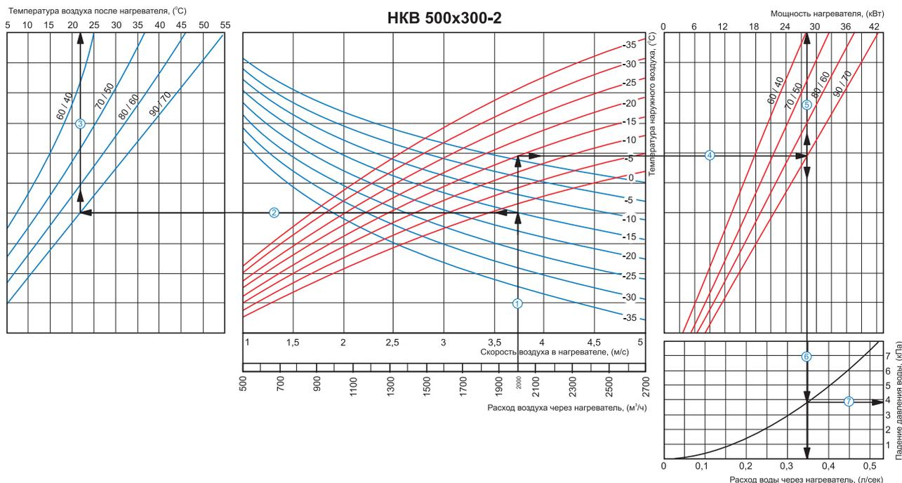
**Пример расчета параметров водяного нагревателя:**
