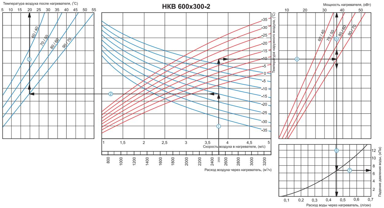
**Пример расчета параметров водяного нагревателя:**
