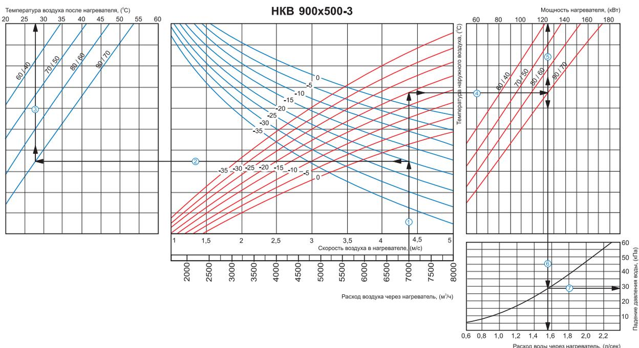
**Пример расчета параметров водяного нагревателя:**
