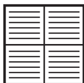
ОНК1, ОНК3 – горизонтальное расположение направляющих воздушного потока
