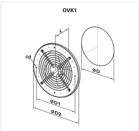
**Außenabmessungen der Ventilatoren**
