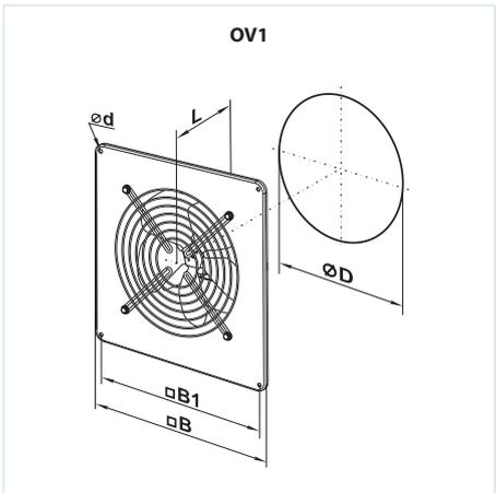
**Außenabmessungen der Ventilatoren**
