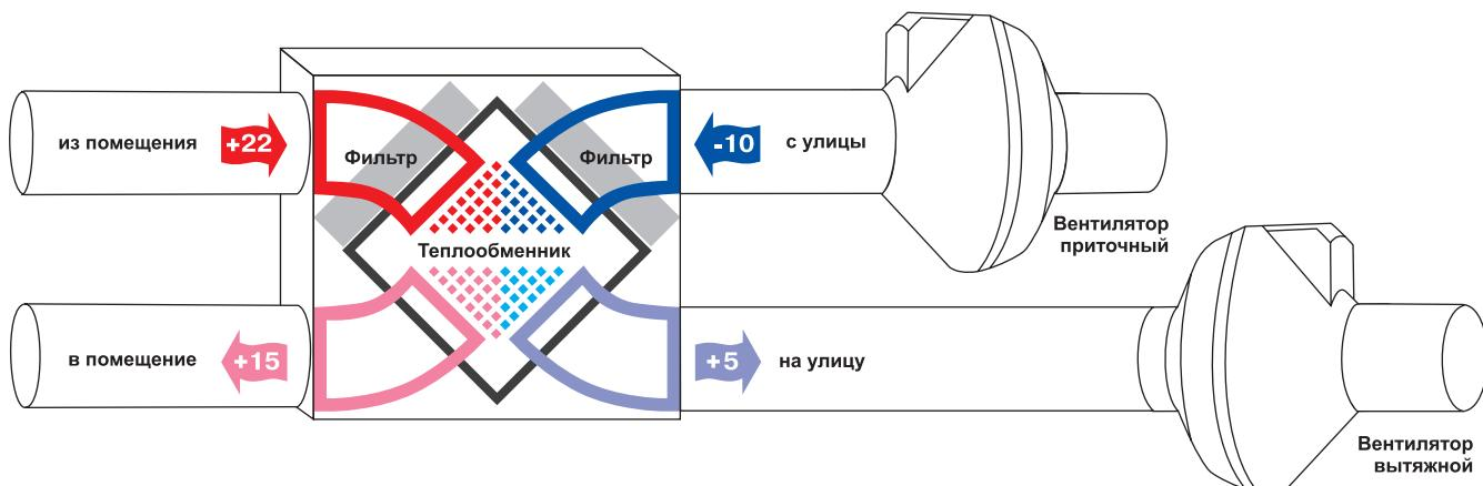
Вариант применения пластинчатого рекуператора в системе вентиляции с вентиляторами серии ВК
