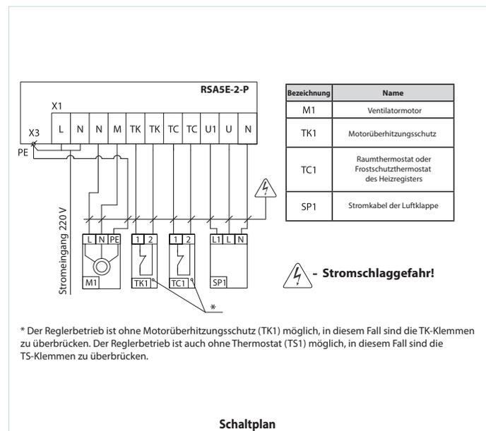
\* Der Reglerbetrieb ist ohne Motorüberhitzungsschutz (TK1) möglich, in diesem Fall sind die TK-Klemmen zu überbrücken. Der Reglerbetrieb ist auch ohne Thermostat (TS1) möglich, in diesem Fall sind die TS-Klemmen zu überbrücken.
