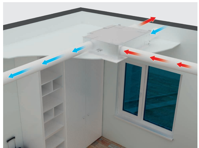
Стельовий прихований монтаж
