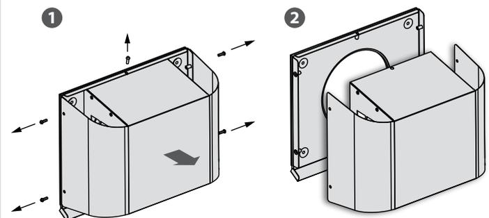
4. Die Rückseite der Lüftungshaube mit den mitgelieferten Schrauben (4 x 40) an der Wand befestigen.
