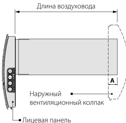
Длина воздуховода зависит от модели проветривателя (см. «Структура условного обозначения»).
