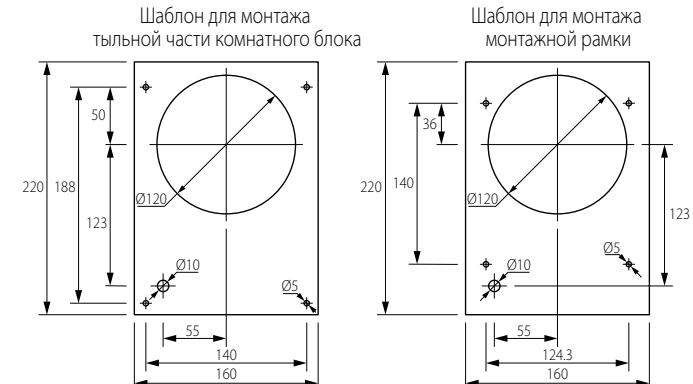
4. Отделите лицевую панель комнатного блока от тыльной части, потянув за язычок снизу. При использовании монтажной рамки закрепите её на стене.
