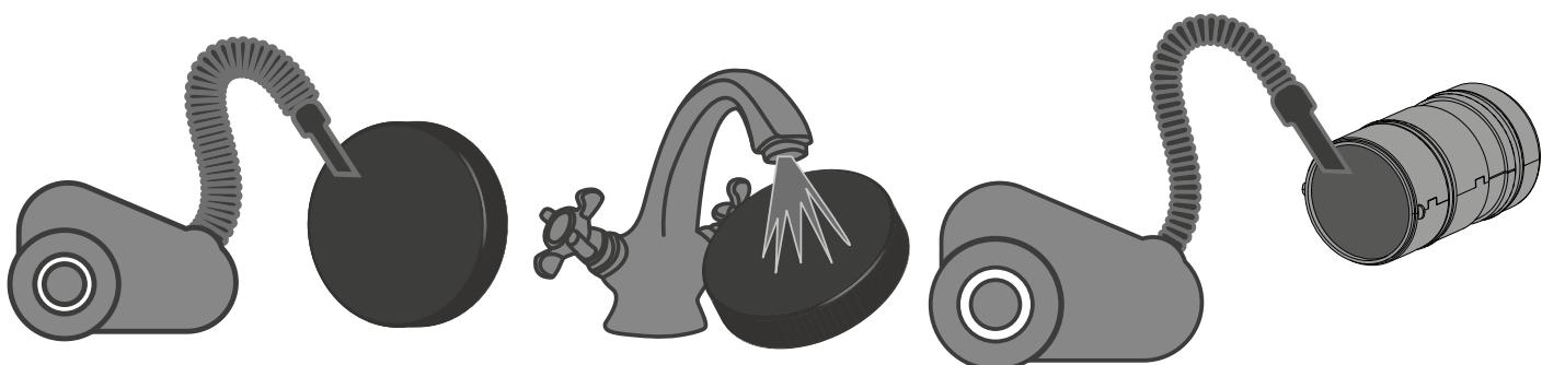
Даже при регулярном техобслуживании фильтров на регенераторе и вентиляторе могут накапливаться пылевые отложения.
