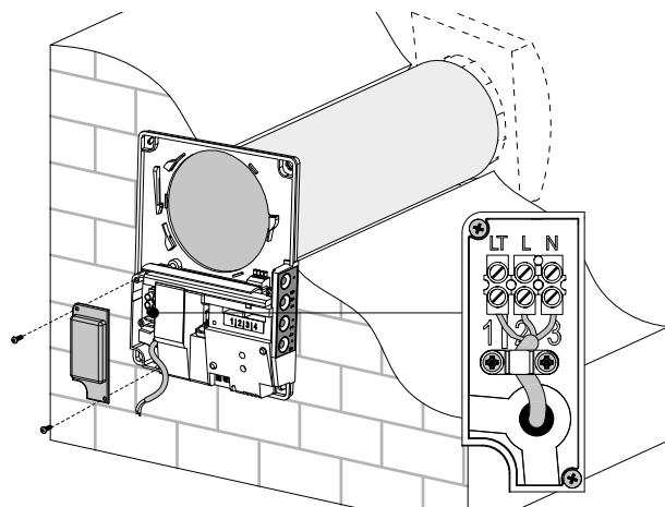
6. Вставьте картридж в канал, подключите разъем картриджа к контроллеру. Установите фронтальную часть комнатного блока на предыдущее место.
