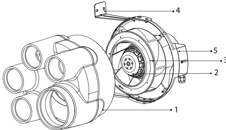
Der Ventilator ist mit einem Einphasen-Außenläufermotor und Radiallaufrad ausgestattet. Das Gerät hat 4 Ansaugstutzen mit einem Durchmesser von 80 mm und 1 Ansaugstutzen mit einem Durchmesser von 125 mm.
