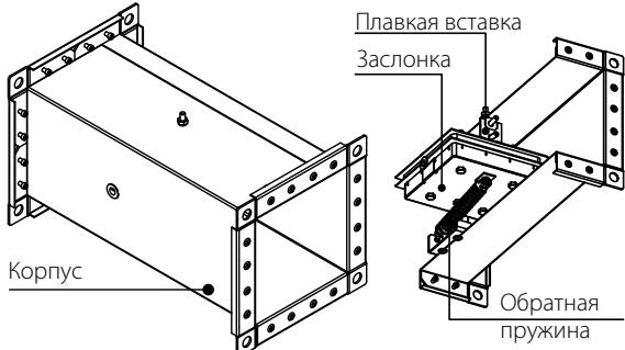
**Клапан противопожарный КП-1...ПКП/КП-1...ПВП/КП-1...ПСП с электроприводом и термоэлектрическим размыкающим устройством**
