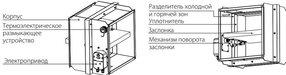
**Клапан противопожарный КП-2...ПКП...-1/КП-2...ПВП...-1/КП-2...ПСП...-1 с электроприводом и термоэлектрическим размыкающим устройством**
