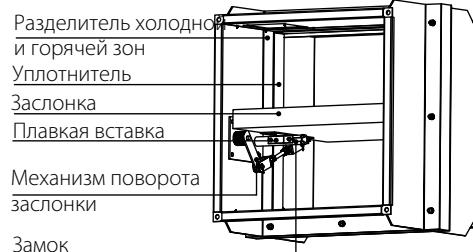
**Клапан противопожарный КП-2...ПКП/ КП-2...ПВП/ КП-2...ПСП с электроприводом и термоэлектрическим размыкающим устройством**
