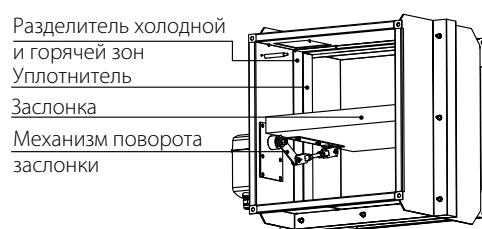
**Клапан противопожарный КП-2...ПКП...-1/ КП-2...ПВП...-1/ КП-2...ПСП...-1 с электроприводом и термоэлектрическим размыкающим устройством**
