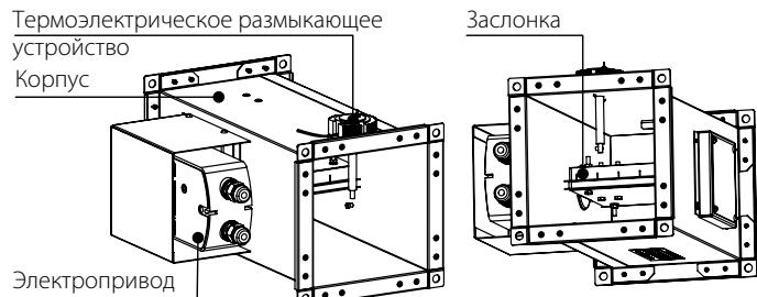
**Клапан противопожарный КП-2...72С с механическим приводным устройством с плавкой вставкой и возвратной пружиной**
