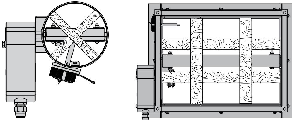
После установки клапана в сечении ограждающей конструкции шахты, стене или перекрытии и полном затвердевании (фиксации) строительного раствора деревянные распорки следует снять. Заслонка должна открываться свободно, без затираний.
