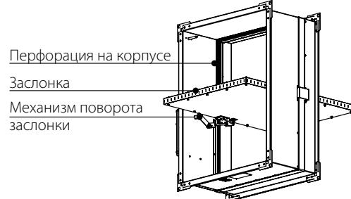
**Клапан противопожарный ПЛ-10-1А с механическим приводным устройством с плавкой вставкой и возвратной пружиной**
