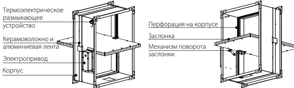
**Клапан противопожарный ПЛ-10-1А с механическим приводным устройством с плавкой вставкой и возвратной пружиной**
