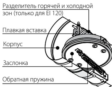
**Клапан противопожарный ПЛ-10-ПКП/ПЛ-10-ПВП/ПЛ-10-ПСП с электроприводом и термоэлектрическим размыкающим устройством**
