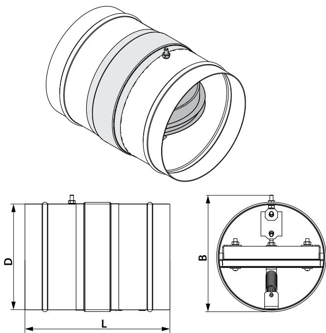
**Клапан противопожарный ПЛ-10-ПКП / ПЛ-10-ПВП / ПЛ-10-ПСП с электроприводом и термоэлектрическим размыкающим устройством**
