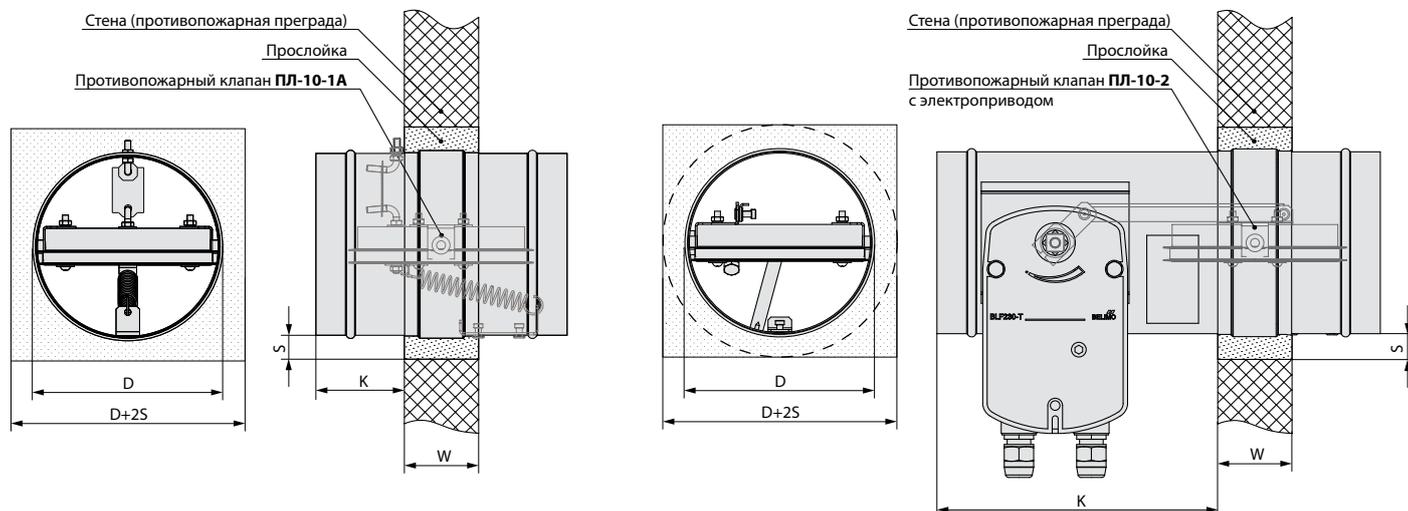
**Противопожарный клапан устанавливается в сплошную потолочную панель**, толщина которой должна составлять не менее **W=150 мм**, минимальная толщина прослойки — **S=50 мм**. Потолочная панель изготовлена из бетона. В качестве прослойки можно использовать бетон или строительный раствор. В процессе установки необходимо учитывать монтажный размер **K**.
