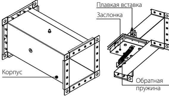
**Клапан противопожарный КП-1...ПКП/КП-1...ПВП/КП-1...ПСП с электроприводом и термоэлектрическим размыкающим устройством**
