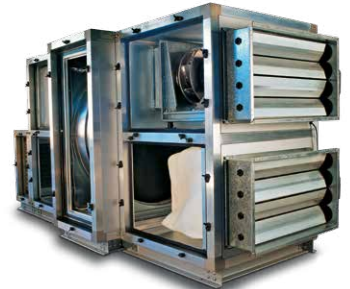
Агрегаты классической конструкции выполнены в корпусах из панелей толщиной 50 мм с алюмоцинковым покрытием на рамах из профиля толщиной 50 мм.
