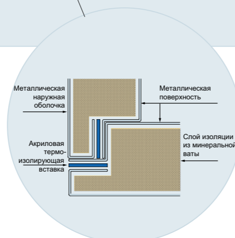
Соединение бескаркасного корпуса
