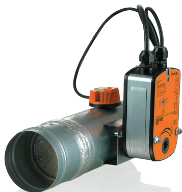
Нормально открытый огнезадерживающий каналный клапан с электроприводом, обратной пружиной и термоэлектрическим прерывателем
