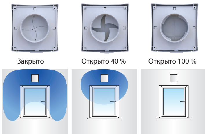
Распределение воздушного потока при различном положении регулятора воздуха
