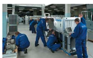
Цех виготовлення припливно-втяжних агрегатів AirVENTS
