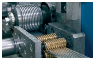
Цех виготовлення гнучких повітропроводів
